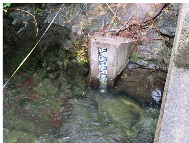
Figure 170 : Echelle de la station hydrométrique du Luri
